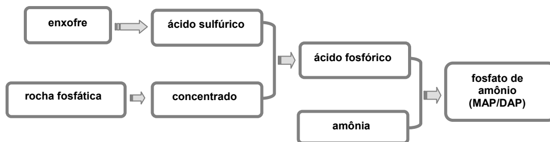
Figura 4 - Esquema de produção de fosfatos de amônio (MAP/DAP).
