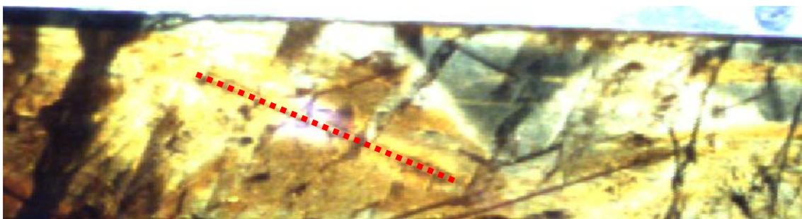
Fig.1 – Imagem mostrando a trajetória do laser paralela à linha pontilhada sobre o cristal de esfalerita.
