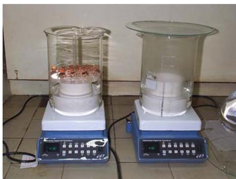
**Fig. 2-** Sistema reacional utilizado nos testes de exposição a vapores.
