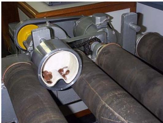
**Fig. 3-** Sistema reacional utilizado nos testes de abrasão.
