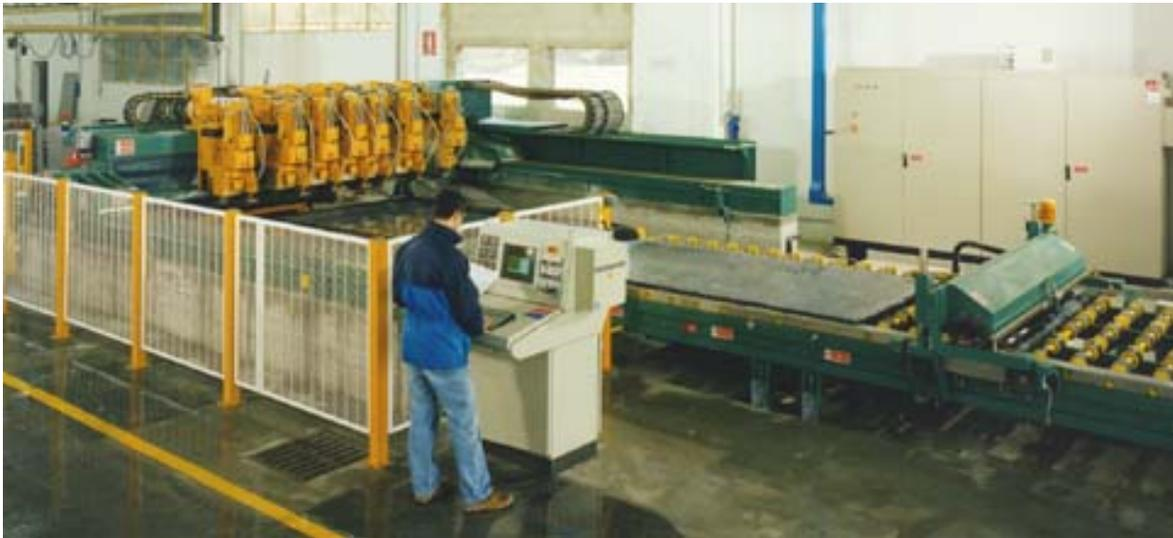
Figura 15 – Entestadeira para corte longitudinal de chapas
