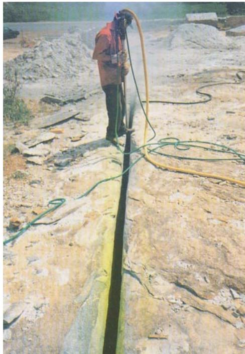
Figura 4 – Maçarico (“Jet flame”)
