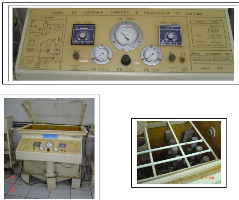
Figura 6 – Vista geral da câmara BASS MP. 65.01/2004. No alto, o painel de controle, em baixo, à esquerda, vista geral da máquina e à direita uma visão do seu interior contendo material para análise. Este equipamento realiza ensaios cíclicos.
