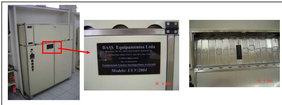
Figura 8– Aspetto geral da câmara de radiações ultravioletas. No lado direito observa-se a câmara aberta com a localização do posicionamento das amostras.
