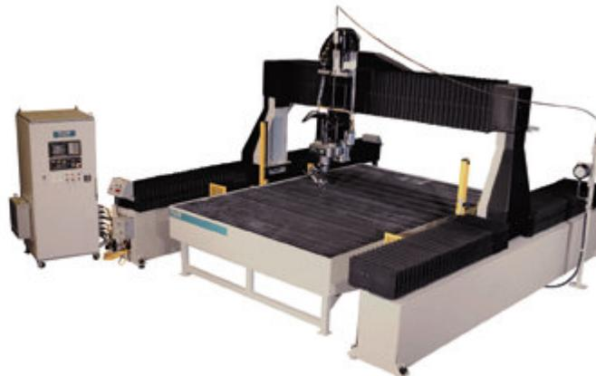
Figura 17 – Equipamento de corte a jato de água sob pressão com controle numérico
