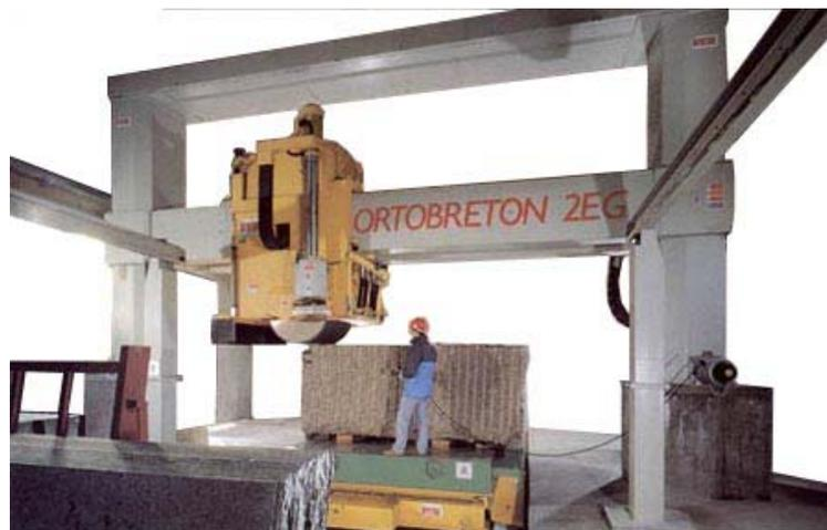
Figura 6 – Talha blocos multidiscos diamantados de 2 colunas
