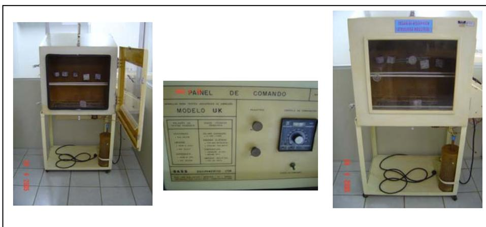
Figura 5 – Vista geral da câmara BASS modelo USC que é um equipamento simples utilizado para a realização de ensaios contínuos de névoa salina e de umidade.
