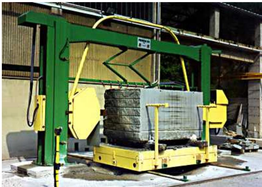
Figura 3 – Tear monolâmina diamantada
