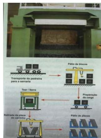
Figura 3 - Tecnologia de Serragem através de Tear.
