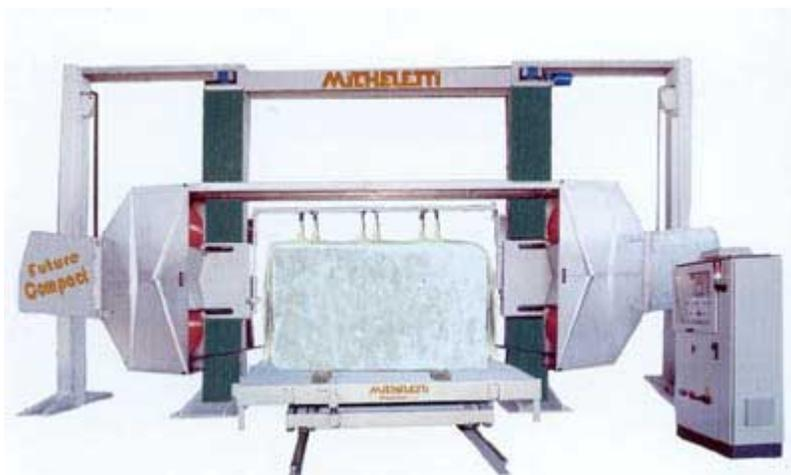
Figura 8 –Tear multifio diamantado para corte de blocos
