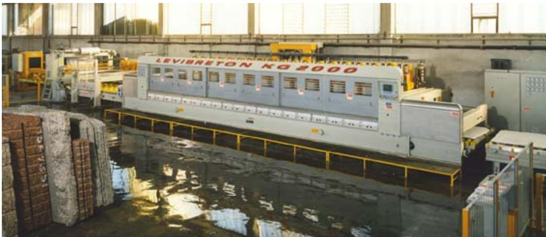
Figura 11 – Politriz automática multicabeças com esteira transportadora
