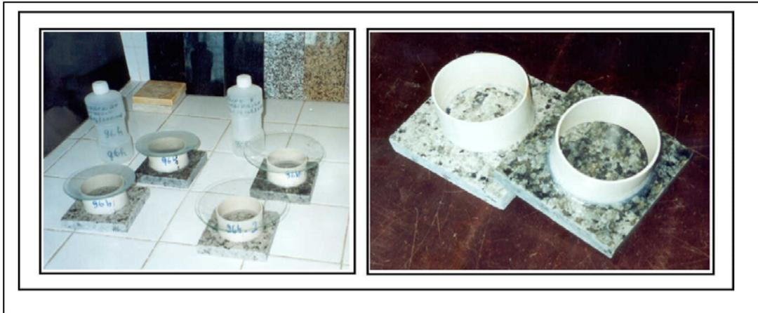
Figura 7 – Aspeto do uso da técnica de *ataque com soluções agressivas*. Neste exemplo, as soluções são colocadas em formas de cano de PVC coladas, com silicone, sobre a pedra.
