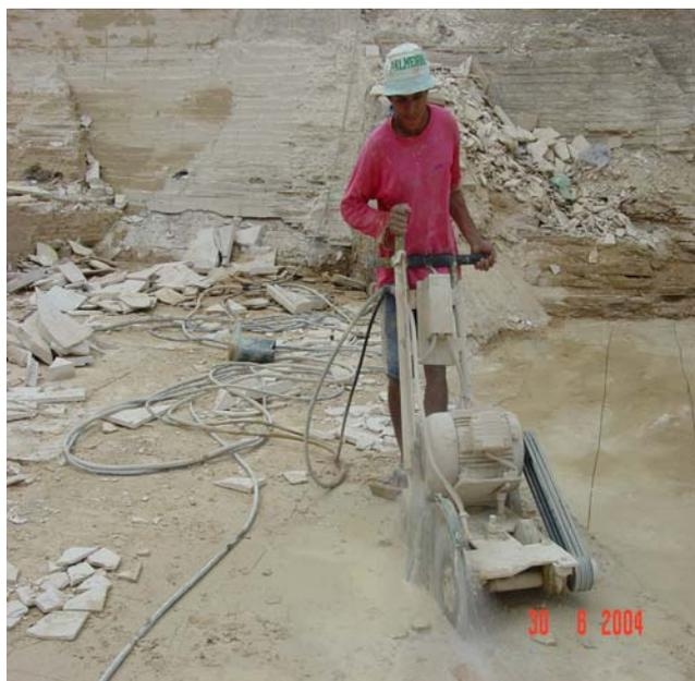
Figura 3 – Método de lavra semi-mecanizado
