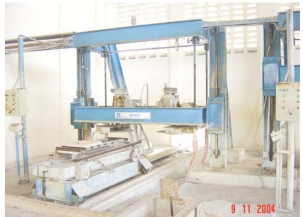
Figura 3 – Talha-Blocos de Fabricação Nacional
