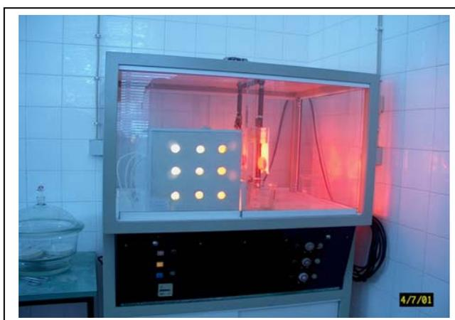
Figura 9 – Vista da câmara de fadiga térmica do IST. Notar a luz vermelha que corresponde à radiação infravermelha atuando diretamente sobre a amostra.
