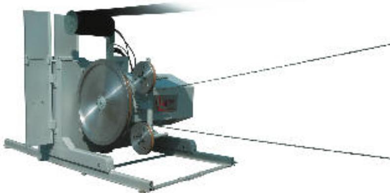
Figura 9 – Fio diamantado
