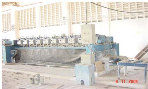
Figura 5 – Máquina de Polimento
