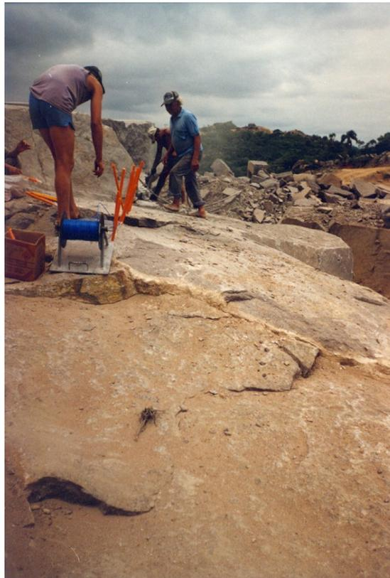
Figura 6 – Corte com uso de explosivos
