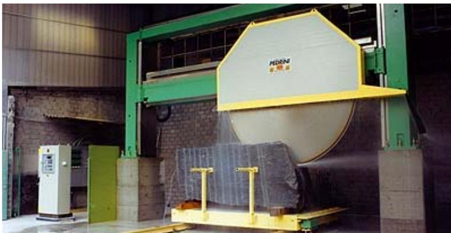
Figura 5 – Talha blocos monodisco para obtenção de espessuras
