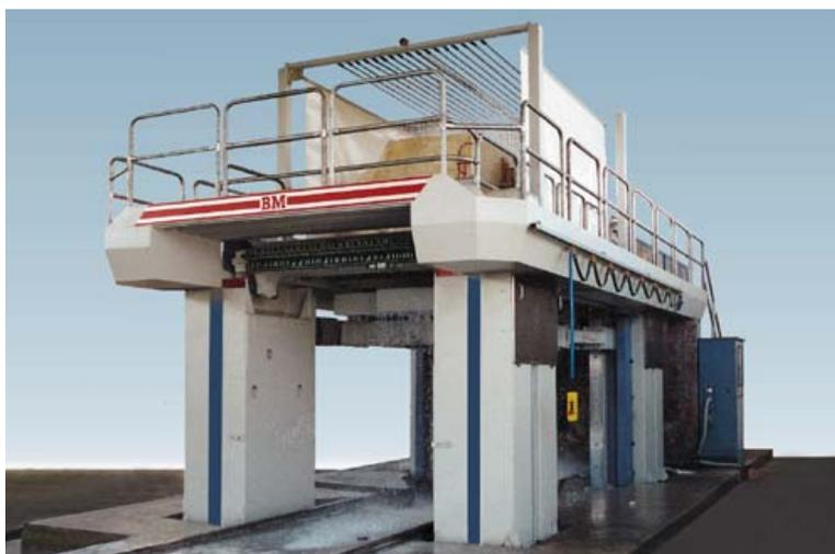
Figura 4 – Tear multilâminas diamantadas
