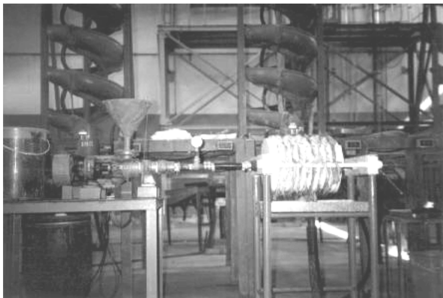
Figura 8 - Unidade de filtro prensa piloto (CETEM) usada no desaguamento da diatomita
