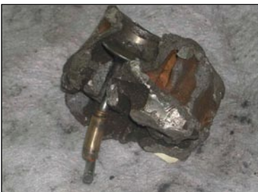
FIGURA 5 – Bloco de motor em alumínio com resíduos de aço e uma válvula em aço misturado com resíduos de latão provavelmente provenientes do carburador.
