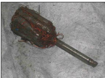
FIGURA 3 – Bobina em aço envolta em fios de cobre. Mistura cobre/aço. FIGURA 4 – Mangueira de borracha com braçadeira. Mistura material orgânico/aço
