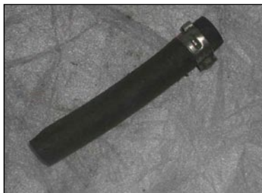
FIGURA 3 – Bobina em aço envolta em fios de cobre. Mistura cobre/aço. FIGURA 4 – Mangueira de borracha com braçadeira. Mistura material orgânico/aço
