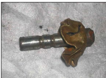
FIGURA 5 – Bloco de motor em alumínio com resíduos de aço e uma válvula em aço misturado com resíduos de latão provavelmente provenientes do carburador.
