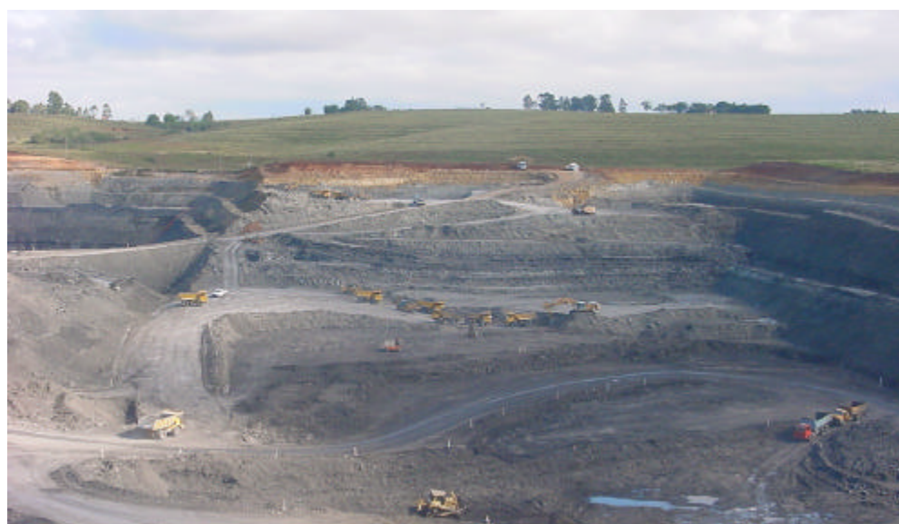
Figura 4 – Lavra em tiras em mina de carvão da Copelmi Mineração, Mina do Recreio, Butiá, Rio Grande do Sul
