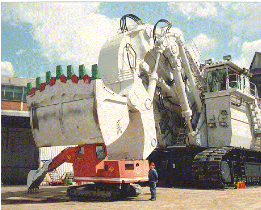
Figura 9 – Evolução dos equipamentos de escavação e carregamento observando-se a tendência de aumento do porte
