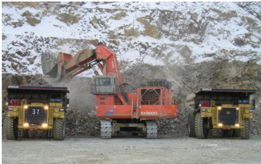
Figura 2 – Operação de carregamento e transporte na Mina de Fort Knox, no Alaska
