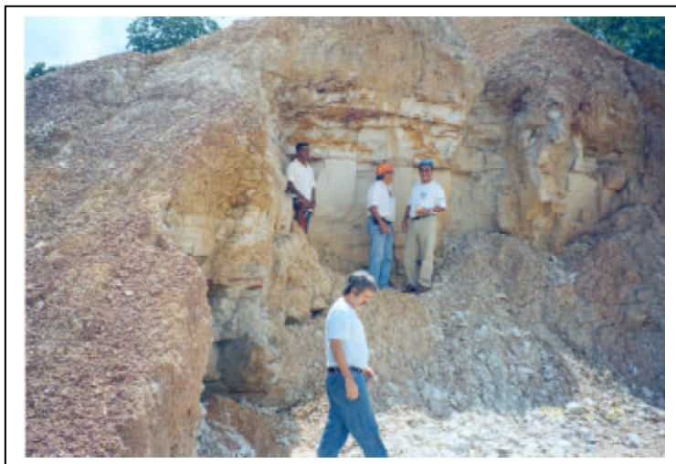
Figura 1 – Mina de Casa Nova (Grupo Brenannd), distrito de Buriti do Rei – pacote argiloso mostrando fratura e soluções ferruginosas (Luz et al. , 2007).
