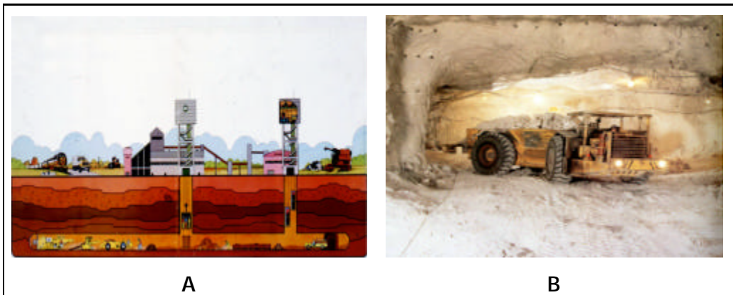
Figura 10 – Em A, corte transversal de uma mina de sal, em B, remoção de sal da frente de lavra (Mina Klodawa – Polônia).
