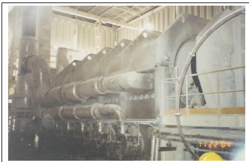
Figura 3 – Forno do tipo rotativo horizontal de queima indireta utilizado no pólo gesseiro do Araripe.
