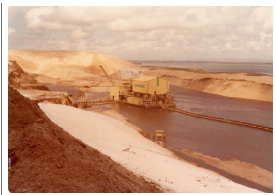
Figura 2 – Lavra de minerais pesados por drenagem ( dredge mining ).
