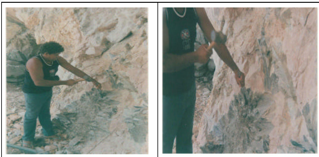
Figura 2 – Lavra manual de moscovita com o uso do “pixote”, na mina de Ubaeira, em Currais Novos, RN.
