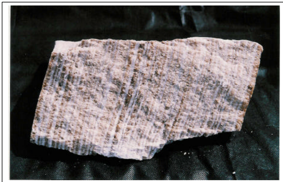
Figura 1 – Variedade de gipsita, utilizada para a produção de gesso \beta , conhecida no Araripe como cocadinha.
