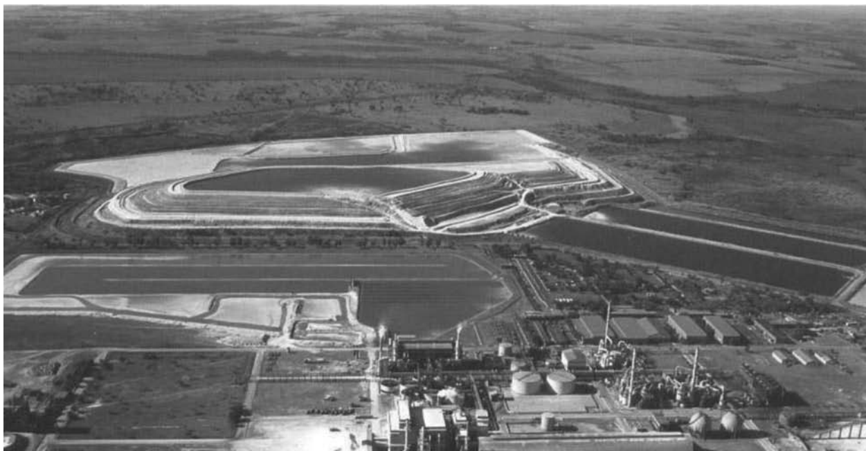
Figura 1.3 – Conjunto de bacias de sedimentação / decantação e de lagoas de processo / resfriamento nas proximidades do complexo industrial da Fosfertil em Uberaba (MG)
