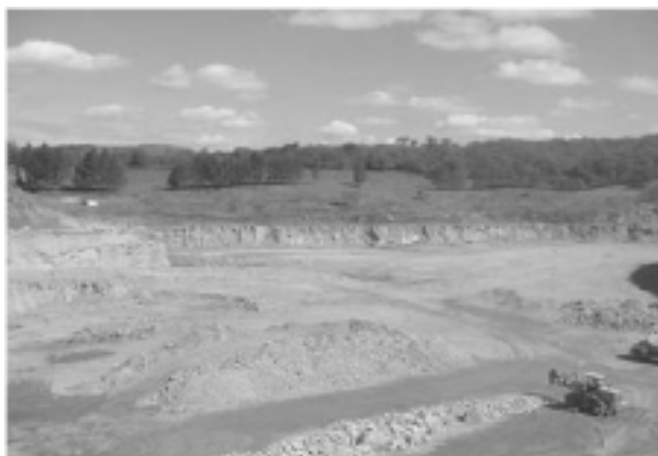
Figura 2.8 - Processo de Lavra a céu aberto de jazida de calcário.
