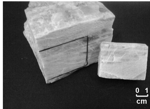
Figura 10 – Preparação dos corpos-de-prova do feldspato microclínio com presença de ferro, corpo-de-prova pronto.
