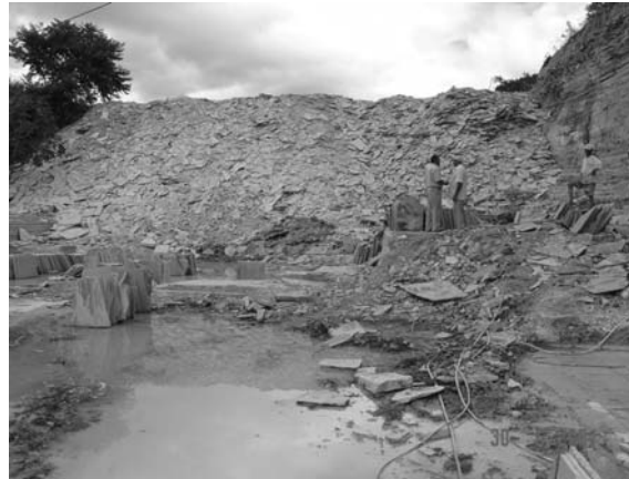
Figura 2 – Disposição inadequada dos rejeitos da lavra
