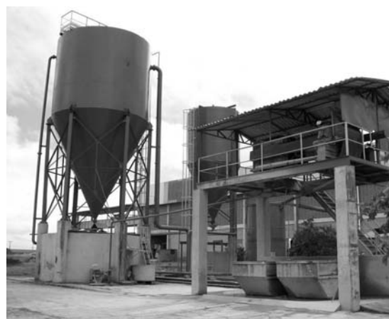
Figura 6 - Decantador vertical conjugado a filtro prensa (à direita). Foto: CETEM/MCT
