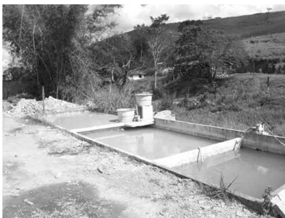
Figura 5 - Tanques de decantação em uma pequena serraria. Foto: CETEM/MCT
