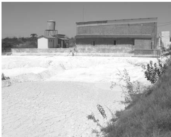
Foto 3 - Finos gerados na serragem de blocos
