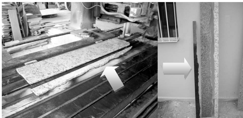
Figura 05 – Tiras resultantes do processo de corte (esquadrejamento). (foto do Autor)
