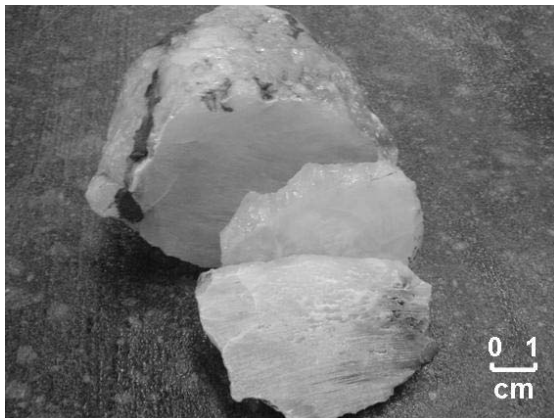
Figura 9 – Preparação dos corpos-de-prova de quartzo
