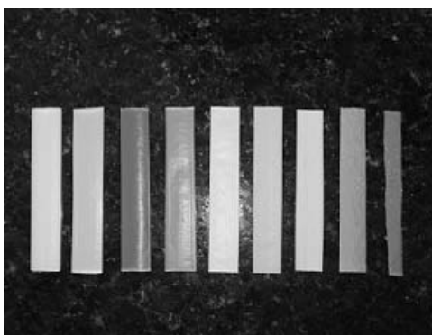
Figura 2 - Corpos-de-prova (fitas) ordenados segundo sua composição de resíduo de mármore.
