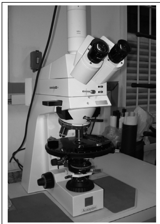
Figura 6 – Microscópio petrográfico utilizado na descrição das lâminas delgadas.
