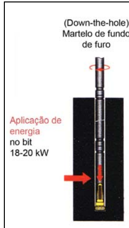
Figura 1 – Perfuração down-the-hole .
