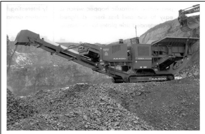
Figura 16 – Unidade móvel compacta incluindo britagem e peneiras. Escavadeiras fazem o carregamento.
