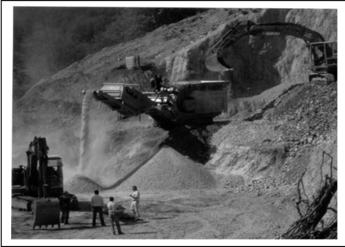
Figura 15 – Peneiras móveis utilizadas diretamente na frente de lavra.
