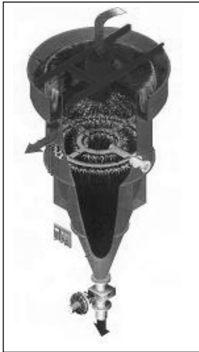
Figura 11 – Classificador vertical por leito fluidizado, "Hydrosizer".
