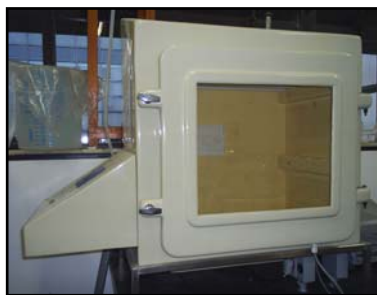
Figura 3.4. Câmara climática para o ensaio de umidade saturada
