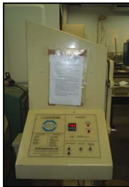
Figura 3.6. Câmara de Exposição ao SO 2
