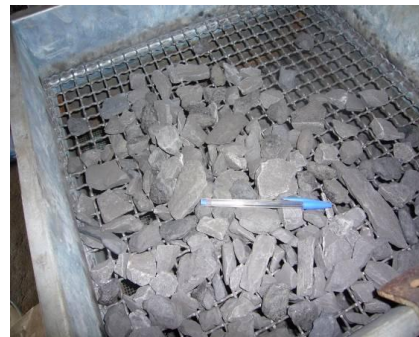
2b. Peneiramento em equipamento vibratório
