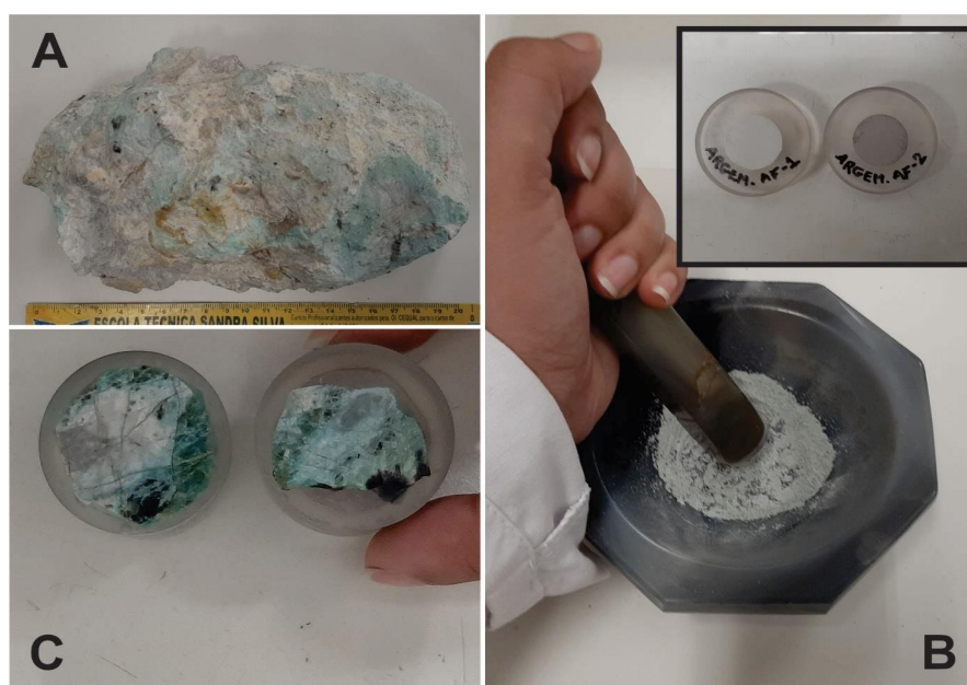
Figura 1 – Materiais e principais passos adotados nesta metodologia. Legenda: A) Amostra de minério de lítio proveniente da mina da Argemela, Portugal; B) Material pulverizado com auxílio de cadinho e pistilo de ágata e posteriormente montado em porta amostras (canto superior direito) para aplicação em DRX; C) Dois fragmentos da amostra original embutidos em resina, polidos e cobertos com carbono para aplicação em MEV.
