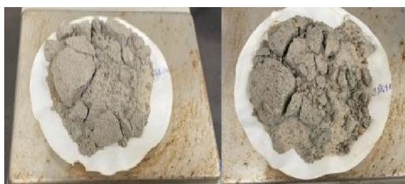
Torta úmida (rejeito arenoso) (a)
