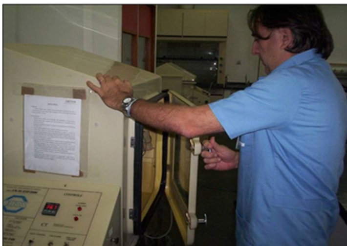
Figura 10: Colocação dos corpos de prova em câmara de SO 2 .
