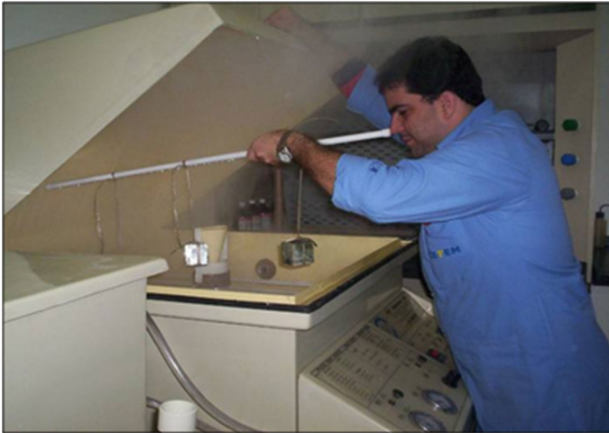
Figura 9: Colocação dos corpos de prova em câmara de névoa salina.
