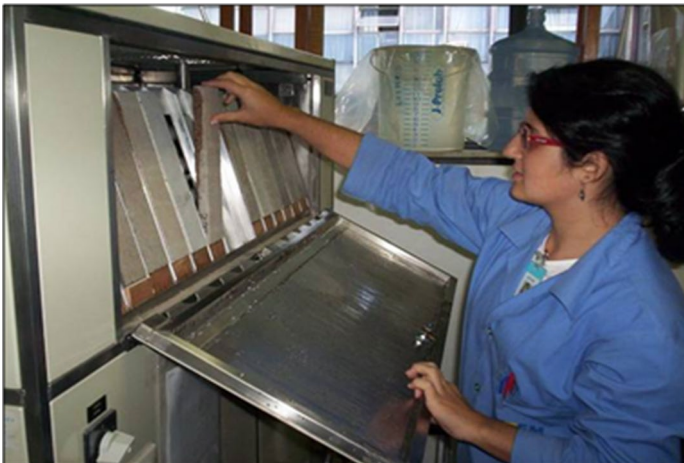
Figura 11: Colocação de corpos de prova na Câmara de UV.
