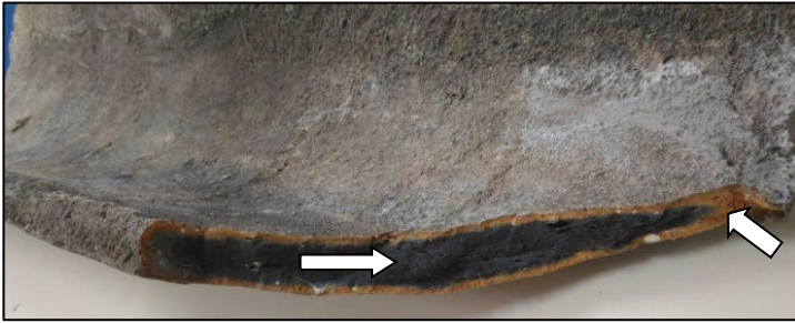
Figura 8: Vista lateral da telha com enfoque para os pontos de FTIR analisados.
