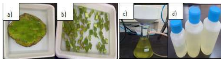
Figura 1. a) cladódio de palma; b) cladódio em cubos imersos em água destilada; c) obtenção da mucilagem por filtragem; d) acondicionamento da mucilagem em frascos de amostras
