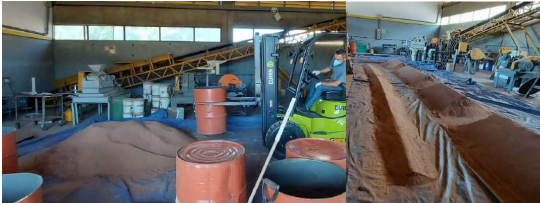
Figura 1. Etapa de homogeneização da amostra, execução da pilha cônica e alongada para caracterização.
