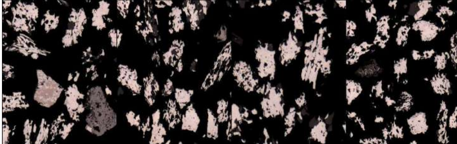
Figura 1. Amostras do conjunto original após converter o valor dos pixels correspondentes à resina para o valor 0 correspondente ao background .
