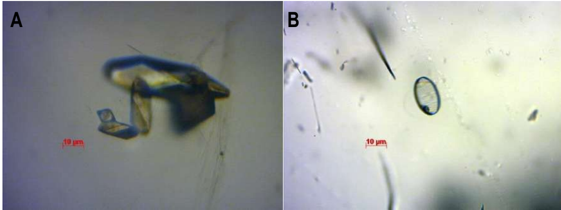
Figura 1. Microscopia óptica das inclusões em cristais de quartzo. A) Conjunto de cristais de arsenoflorencita-(La). B) Inclusão anelar constituída de óxido de manganês e bário.
