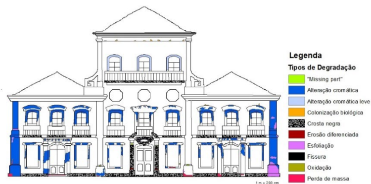
Figura 3. Mapeamento de danos da Fachada do Paço Imperial.
