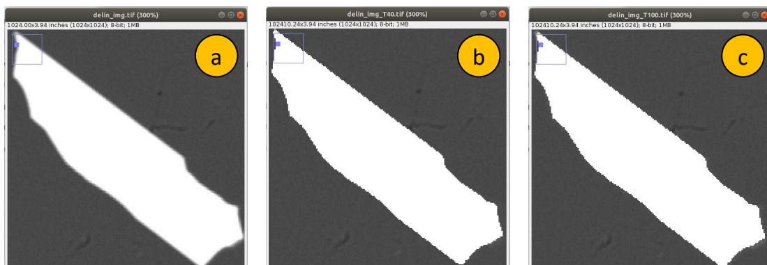
Figura 4. Detalhe da imagem de teste mostrando o resultado da aplicação do plugin Delin_vips: (a) imagem original; (b) resultado com T = 40 ; (c) resultado com T = 100 .
