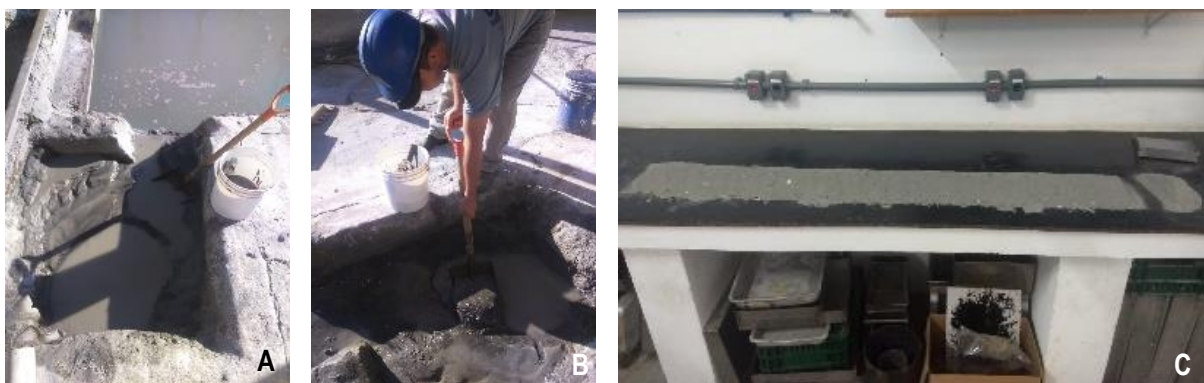
Figura 1. Coleta dos resíduos da serragem (A e B) e quarteamento das amostras para obtenção das alíquotas (C).
