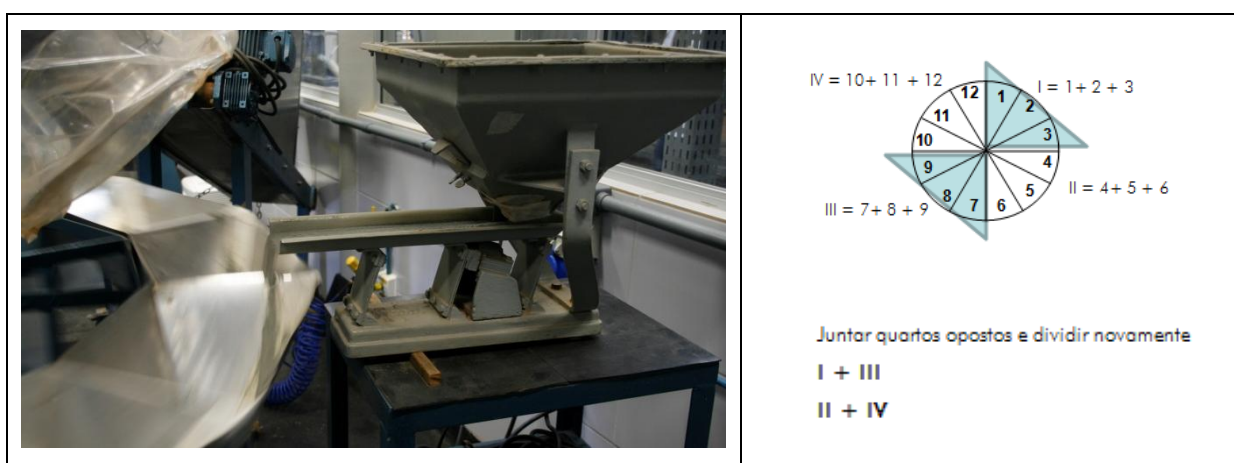
Figura 2. Processo de amostragem e esquema de quartearamento
