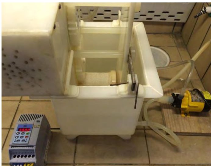
Figura 11. Sistema reacional utilizado na lixiviação da amostra de sucata.
