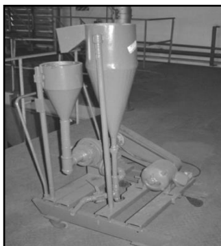
Figura 4. Equipamento afunda-flutua que usa suspensões na separação.
