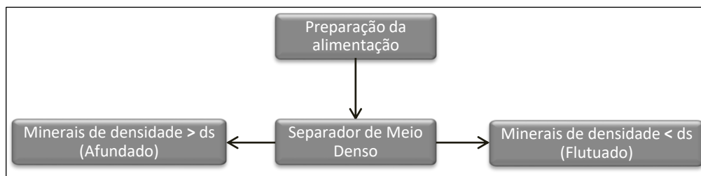
Figura 2. Princípio da separação em meio denso.
