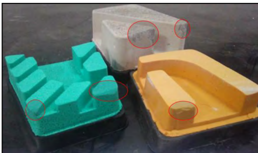
Figura 30. Rebolos fraturados e com desgaste.
