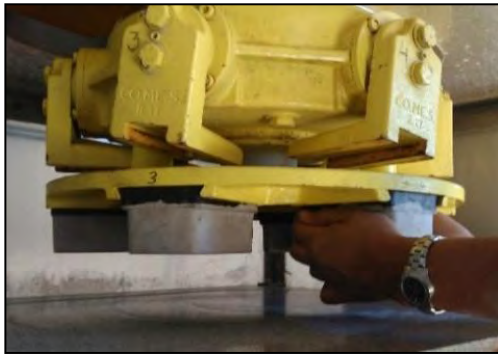
Figura 27. Equipamento para polimento de mármore. (A) Abrasivos do tipo Frankfurt; (B) Prato de fixação dos rebolos; (C) Interação entre rebolo e rocha.
