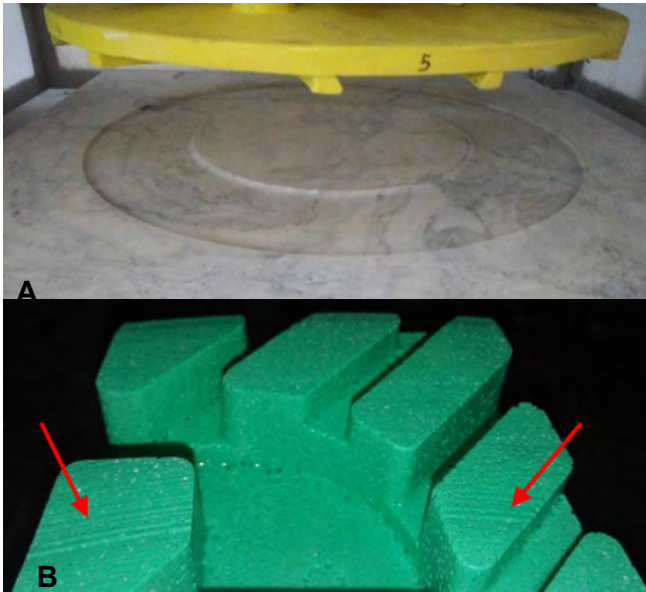
Figura 31. (A) Chapa de mármore aplicada no procedimento de desgaste dos rebolos resinóides. (B) Detalhe dos sulcos no rebolo.
