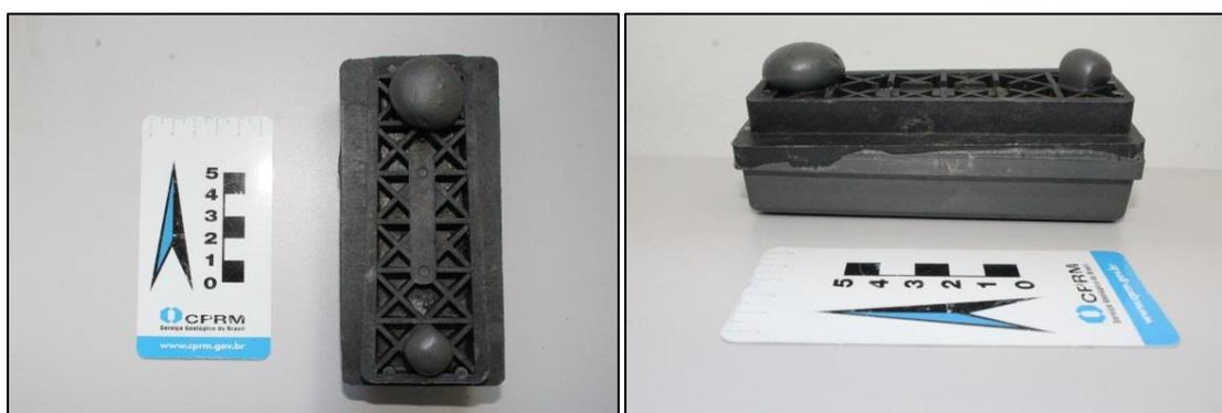
**Figura 2:** Expansão da reação de polimerização no procedimento 1.
