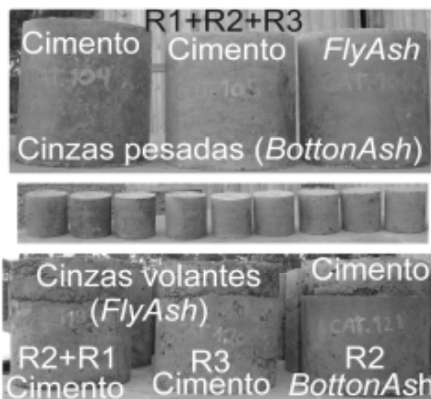
Figura 2 – Corpos-de-prova de pasta mineral com rejeitos totais R1-R2-R3 do LBV (Camada Bonito) com adição de cimento NPC (5%), fly ash (5%) e botton ash
