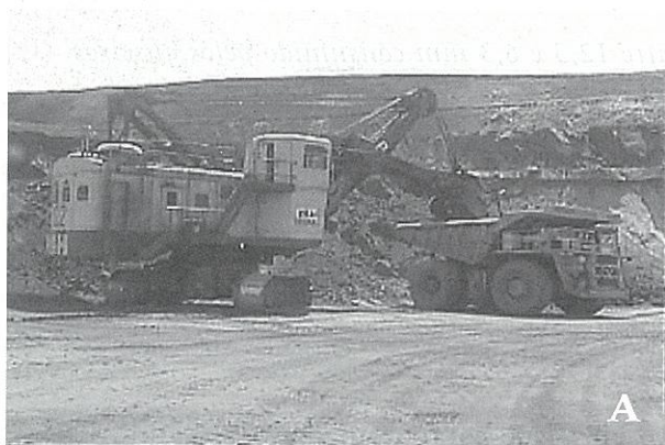
Figura 1: (A) Escavadeira mecânica. (B) Carregadeira frontal em operação na lavra.
