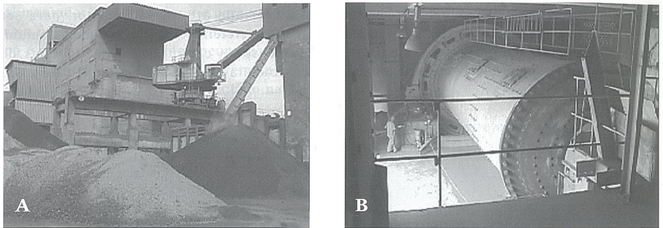
Figura 6: (A) Pátio de estocagem de clínquer. (B) Moinho de cimento.
