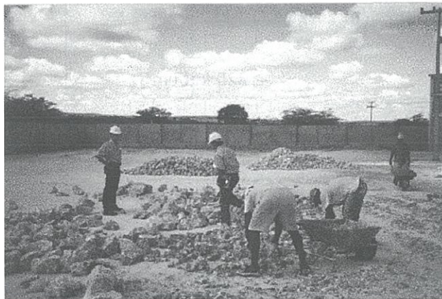
Figura 2: (A) Pátio de catção manual da gipsita na unidade industrial da MINERAÇÃO SÃO JORGE. (B) Sistema de alimentação da autoclave por vagonetas.
