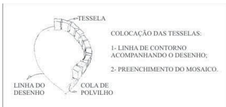
Figura 3: Esquema - procedimento para colocação da tesselas
