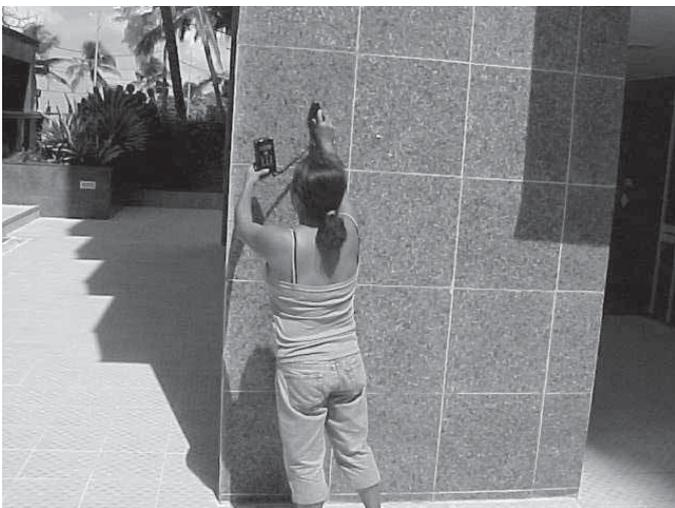
Figura 5 – medição do brilho em revestimento pétreo
