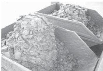
**Figura 1:** Lama Abrasiva (Serragem)
