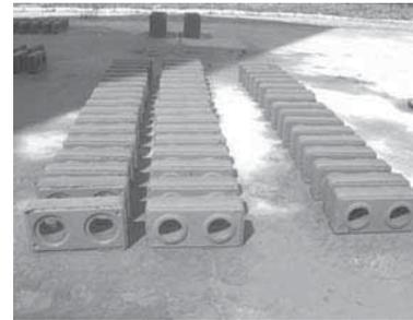
**Figura 12:** Tijolo de solo-cimento com lama abrasiva
