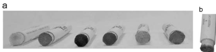
Figura 3 - (a) Fotografia de bastões LeadCheck mostrando resultados positivos, negativos e inconclusivos. (b) Vista do bastão sujo com rosa visível por trás da ponta superior (Smith et al. , 2007).
