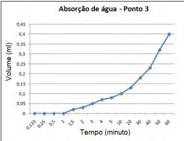
Figura 67. Gráfico de absorção de água por tempo no ponto 3.
