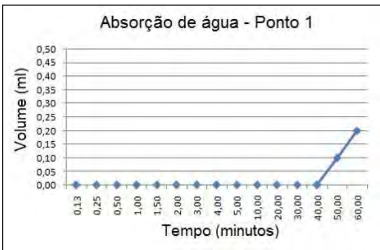
Figura 64. Gráfico de absorção de água por tempo no ponto 1.
