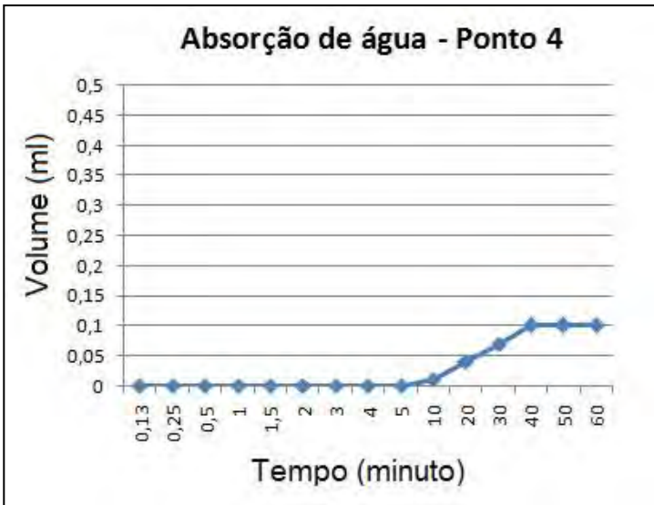
Figura 68. Gráfico de absorção de água por tempo no ponto 4.
