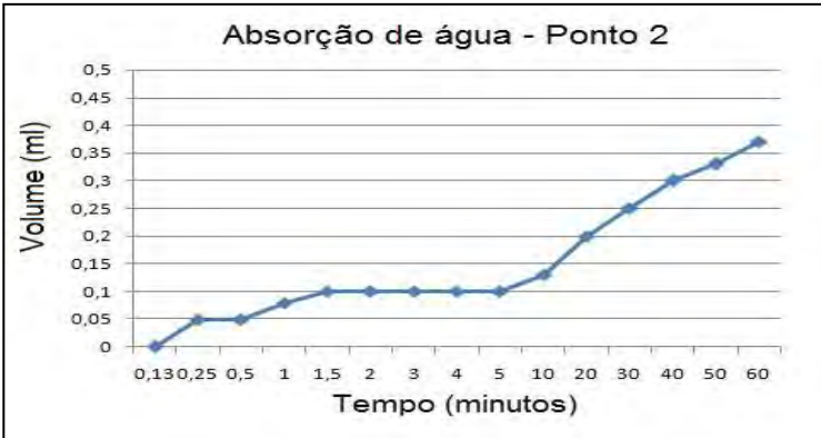
Figura 65. Gráfico de absorção de água por tempo no ponto 2.
