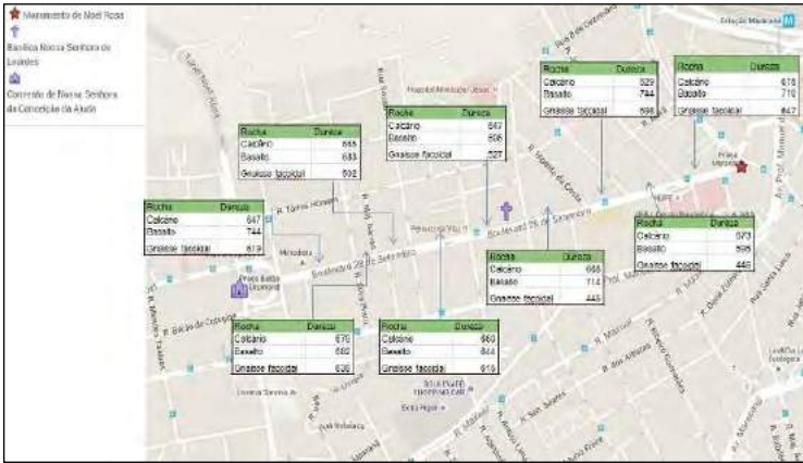
Figura 56. Valores médios de dureza para rochas dos quarteirões norte do Boulevard 28 de Setembro: rochas da calçada musical (calcário e basalto) e do meio-fio (gnaisse facoidal). Adaptado do Google Maps.
