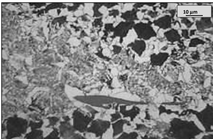
Figura 3. Metalografia de um aço carbono com inclusão de sulfeto.
