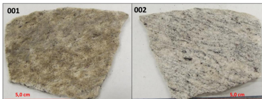
Figura 2: Tonalidade bege da parte exposta do leptinito (001) em contraste com a região protegida da peça (002).
