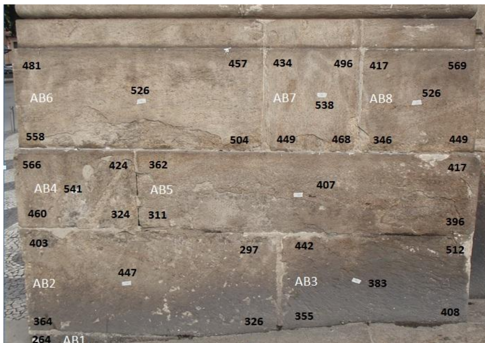
Figura 3: Indicação de como foram realizados os testes de dureza
