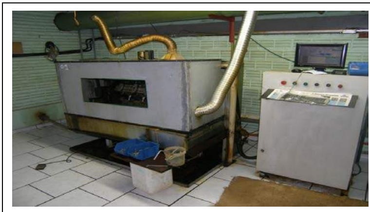
Figura 10. Máquina Lapidadora Múltipla de Cabochões com Controle CNC.
