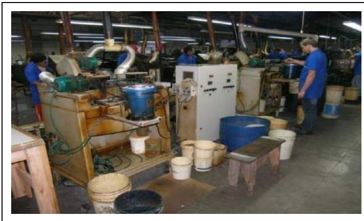
Figura 9. Torno duplo automático com controle CLP.
