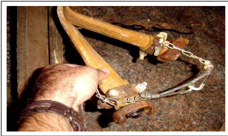
Figura 6. Sistema de segurança para engate rápido.
