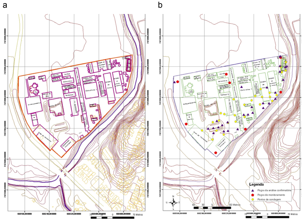
Figura 3 Atualização dos galpões e limites da indústria (a). Mapeamentos dos poços de sondagem (b).
