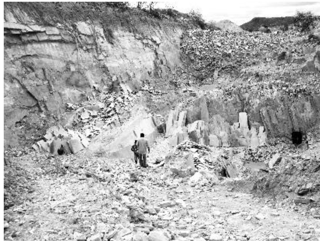
Figura 49 - Resíduos acumulados em pedreira. Foto: CETEM/MCTI, 2004.
