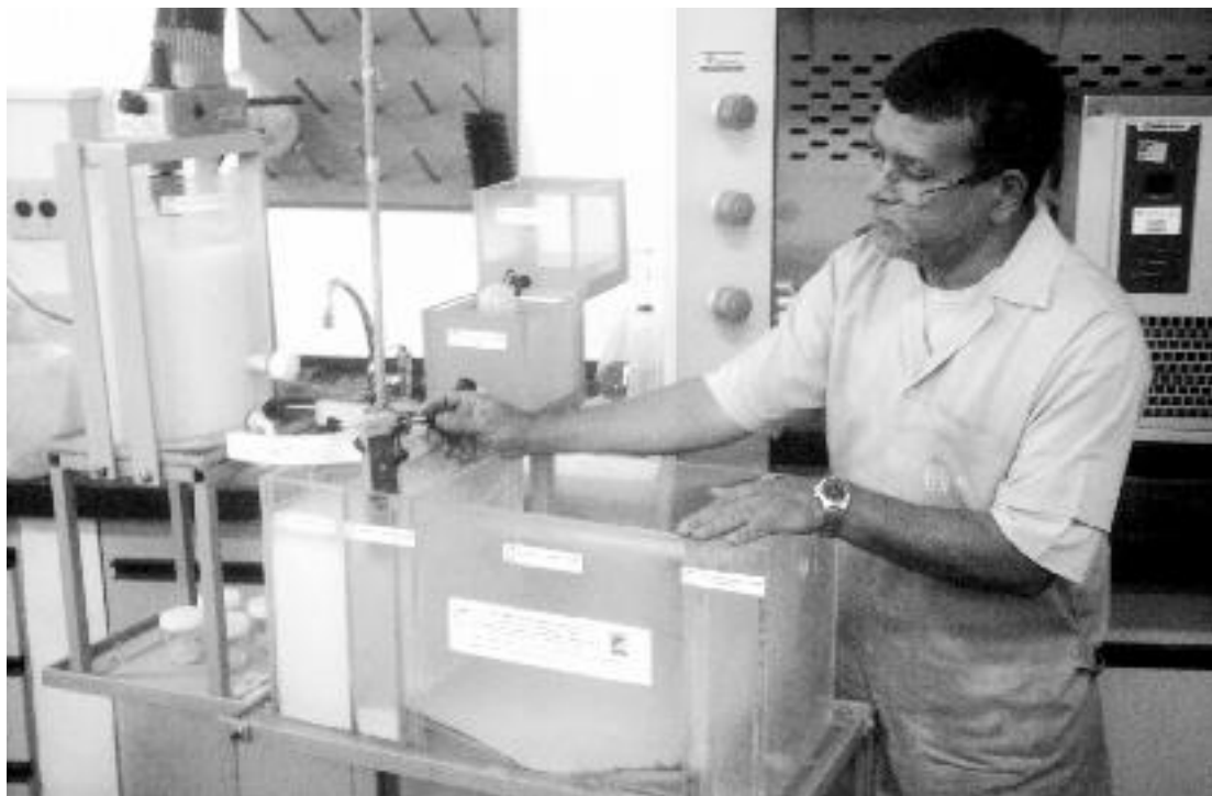
Figura 43 - Protótipo de tanque de decantação desenvolvido para as serrarias de Santo Antônio de Pádua. Foto: CETEM/MCTI, 2001.
