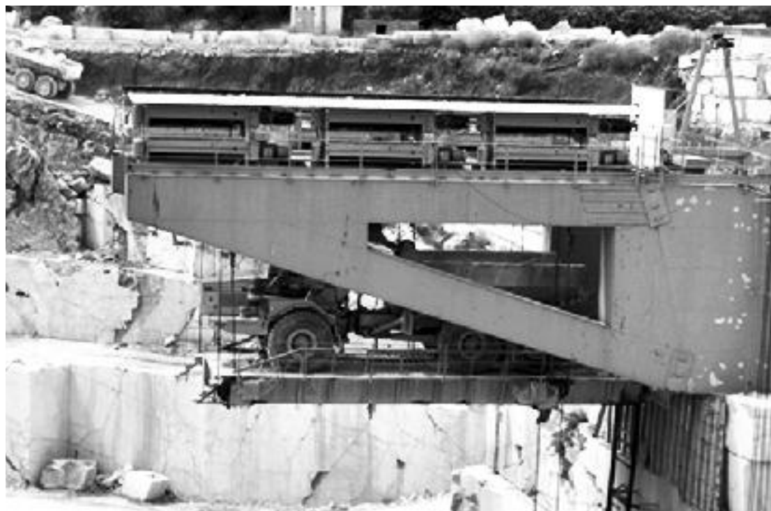
Figura 105 - Chegada do caminhão de estéreis no topo da cava. Foto: CETEM/MCTI, 2007.
