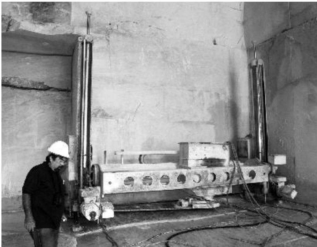
Figura 44 - Cortadora a corrente diamantada em lavra subterrânea. Foto: CETEM/MCTI, 2008.
