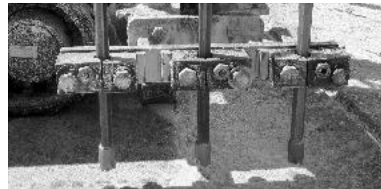
Figura 67 - Bits de perfuração montados nas hastes. Foto: CETEM/MCTI, 2012.
