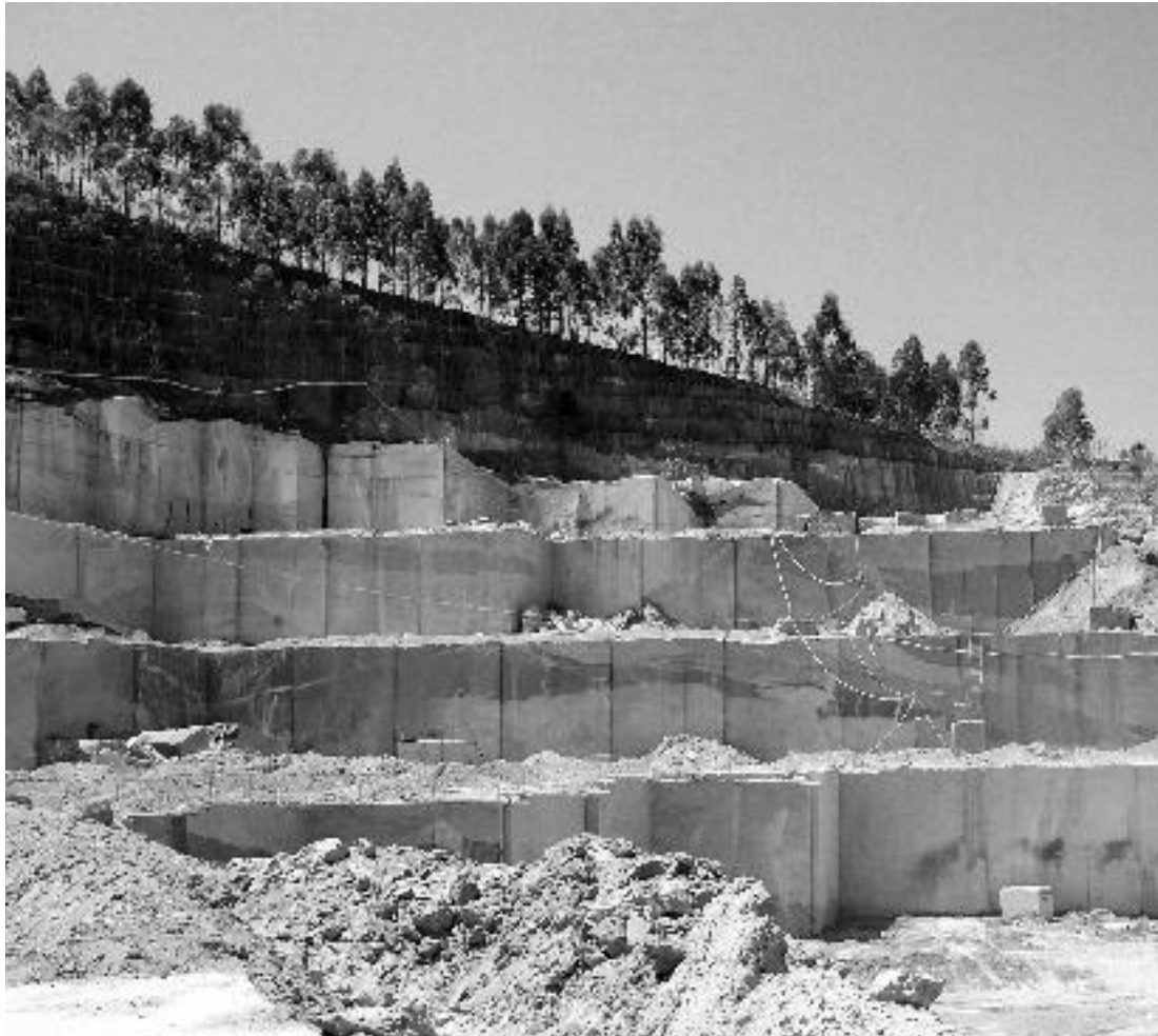
Figura 19 - Lavra por bancadas altas com geometria em “L”. Foto: CETEM/MCTI, 2010.
