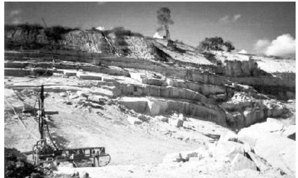
Figura 26 - Lavra por bancadas baixas cujas alturas são definidas naturalmente pela esfoliação esferoidal presente no maciço rochoso. Foto: José Roberto Pinheiro, 2003.
