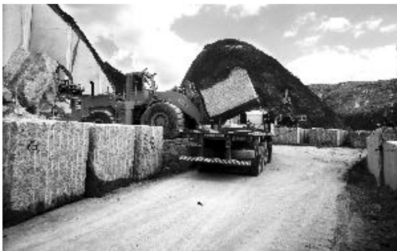
Figura 99 - Carregamento de blocos com o auxílio de pá carregadeira. Foto: CETEM/MCTI, 2011.
