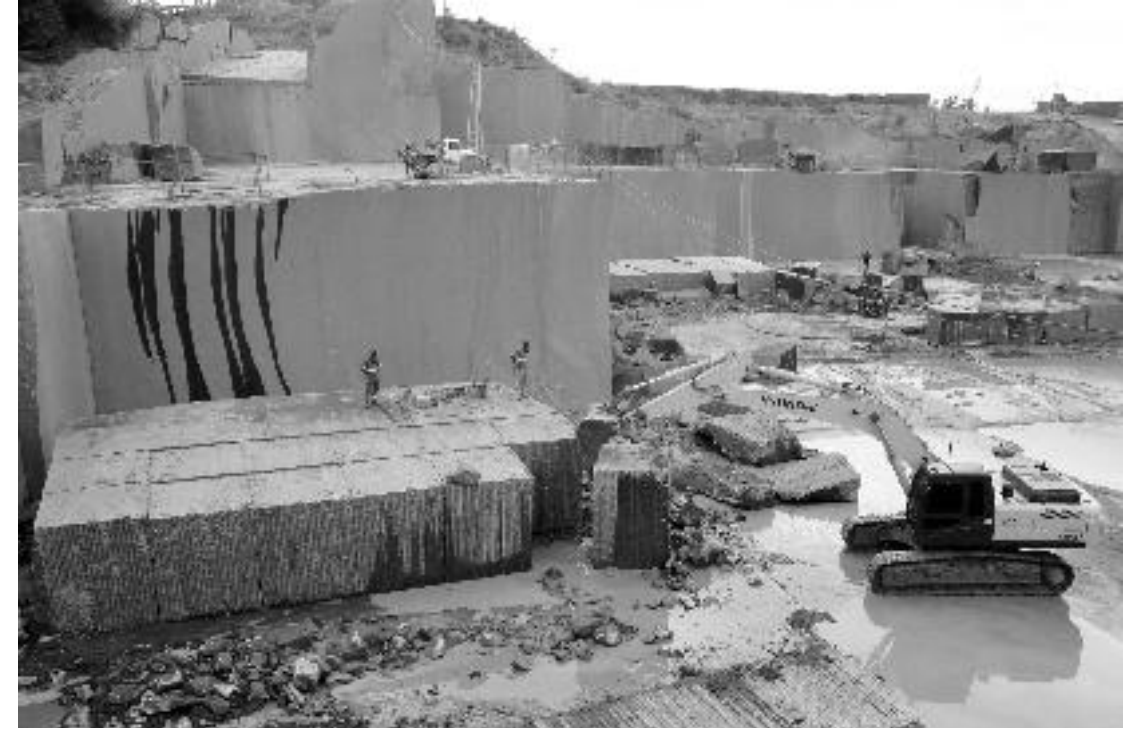
Figura 24 - Movimentação dos blocos cortados da prancha. Foto: CETEM/MCTI, 2012.
