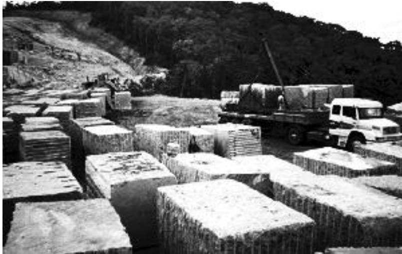
Figura 97 - Pau de carga usado no carregamento do caminhão. Foto: CETEM/MCTI, 2012.
