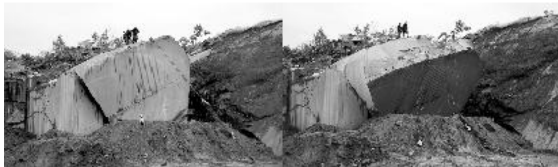
Figura 85 - Exemplo da prática do "moitão" para o tombamento do painel. Fotos: Granitos FUJI, 2009.
