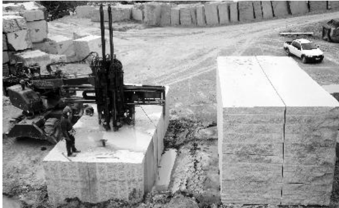
Figura 59 - Perfuratriz hidráulica (banqueadora) usada para o esquadrejamento de blocos. Foto: CETEM/MCTI, 2012.
