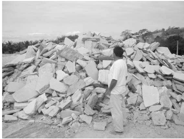
Figura 03/04 – Tiras e montanhas de rejeitos que se avolumam nos pátios das indústrias. As tiras são oriundas do processo de esquadrejamento das chapas, resultando em grande quantidade de sobras do processo industrial. (Fotos do autor)
