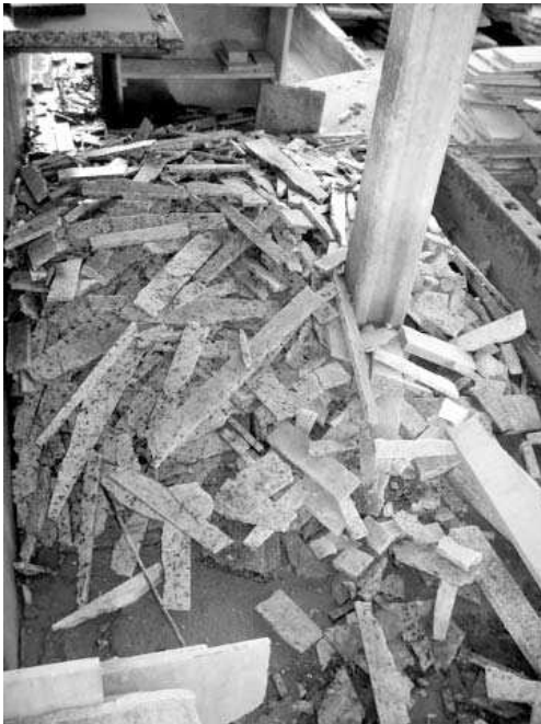
Figura 03/04 – Tiras e montanhas de rejeitos que se avolumam nos pátios das indústrias. As tiras são oriundas do processo de esquadrejamento das chapas, resultando em grande quantidade de sobras do processo industrial. (Fotos do autor)
