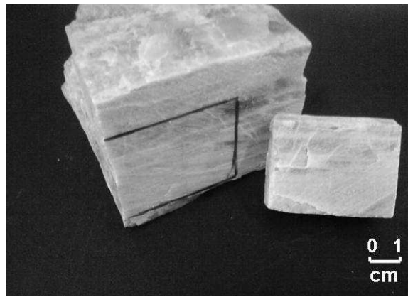
Figura 10 – Preparação dos corpos-de-prova de feldspato microclínio com presença de ferro, corpo-de-prova pronto.
