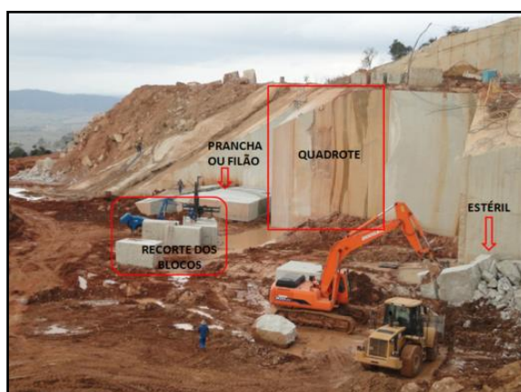
Figura 1. Método de lavra por bancadas
