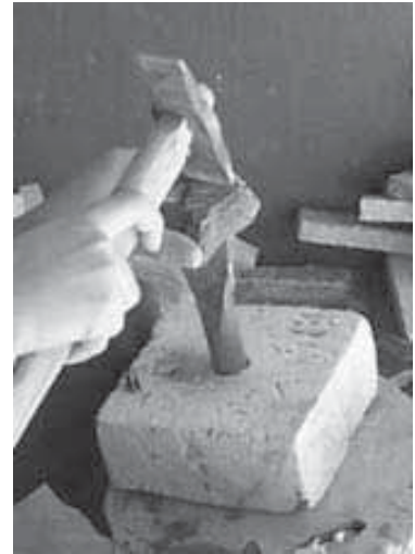
Figura 2: Utilização da martelina e do tagliolo na geração de tesselas.
