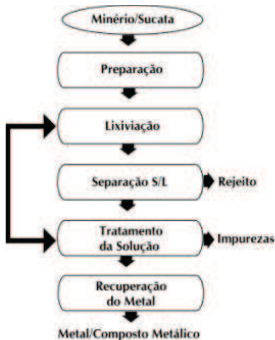
Figura 1 - Etapas principais de um fluxograma hidrometalúrgico
