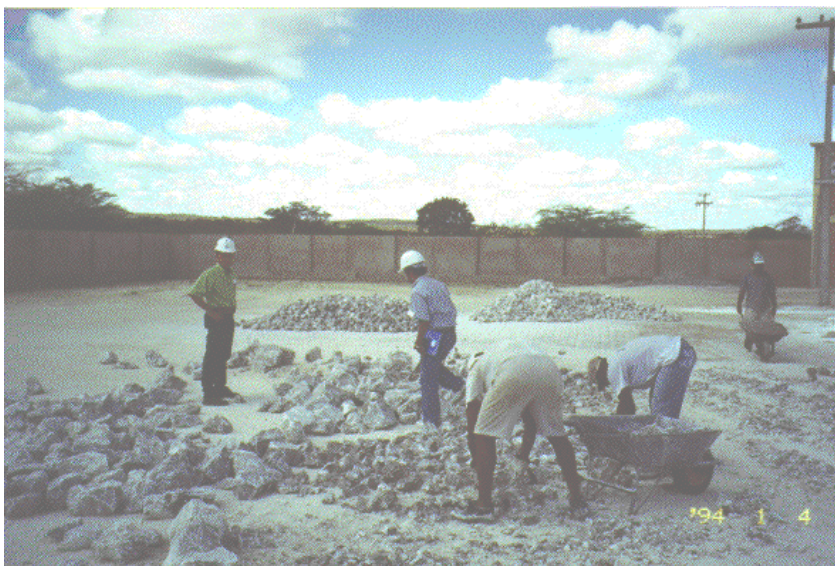
Figura 4: Pátio de catação manual da gipsita da Mineradora São Jorge em Ouriciri-PE.
