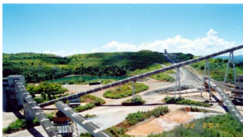
Foto 5: Área industrial: correias transportadoras e banca de deposição de estéril e rejeito.
