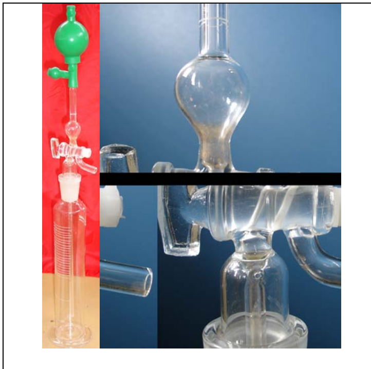
Figura 1 – Pipeta de Andreasen; montagem (sem suspensão) e detalhe do bulbo e da torneira de duas vias (DEMIN/EM/UFOP).
