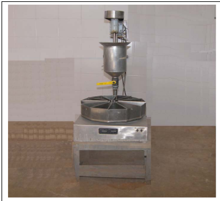
Figura 10 – Quarteador de polpa utilizado para quarteamento de amostras obtidas em operações piloto e/ou industrial.
