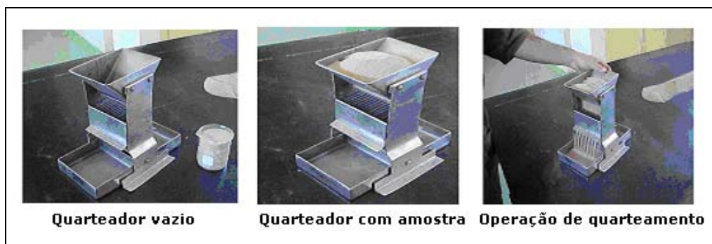
Figura 16 – Ilustração sequencial do quarteamento de uma amostra em um quarteador Jones.
